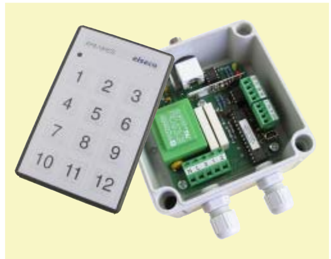
Funkfernsteuer-Empfänger EFB-USB-RS485-PS94 und Funk-Handsender EFS-12HCS
