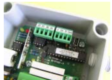
Schnittstellen USB-Buchse, USB-Klemmen und RS485-Klemmen (steckbar)
