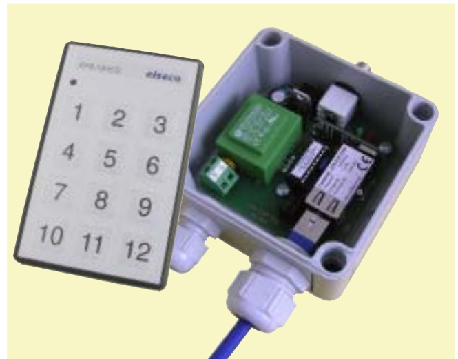
Funkfernsteuer-Empfänger EFB-EXP-PS94 und Funk-Handsender EFS-12HCS
